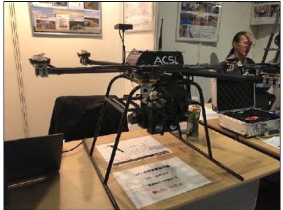
ドローンコンソーシアムは、ドローン企業でいち早く上場を果たした国内ドローンメーカーACSL（自律制御システム研究所）のドローン展示です。地形測量専用機として紹介し、災害時の地形の状態を計測、記録できます。迅速に現地の状況を把握し、インフラ復旧などに活かすことを前提としているのでしょう。楽天での配達にも使われていたので、自動プログラミング飛行を前提とした運用でした。
